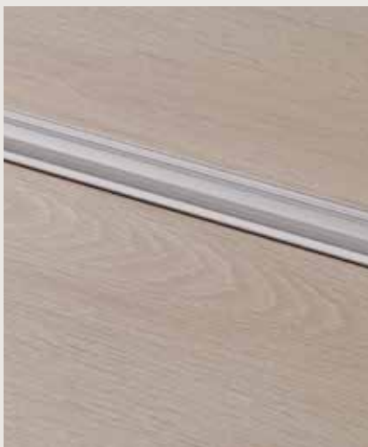
PERFIL MULTIFUNCIONAL PLATA 1860 × 47 × 16 mm El perfil multifuncional Pergo puede nivelar diferencias de altura para crear una transición suave a cualquier otro tipo de suelo. Adecuado para diferencias de altura de 0 a 12,3 mm. Superficie: aluminio.
