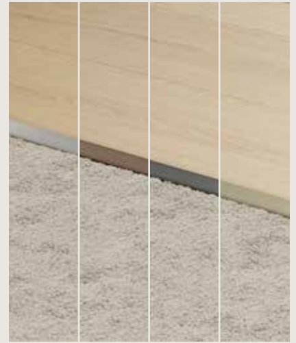
PERFIL FINAL 2000 × 24 × 7 mm Para cubrir la junta de dilatación entre un suelo y, por ejemplo, una pared, una ventana o un umbral. Superficie: aluminio. Disponible en varios colores: plata, café, arcilla y champán.
